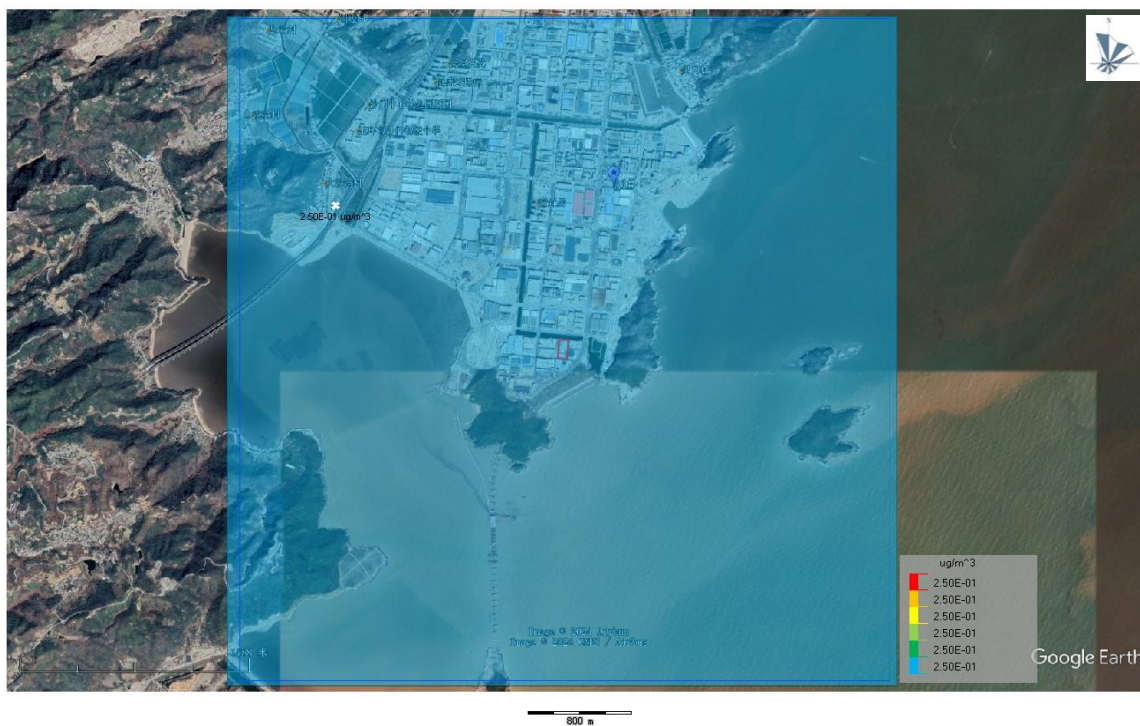
图 5.1-7 叠加后保护目标和网格点处铅小时平均质量浓度分布图
