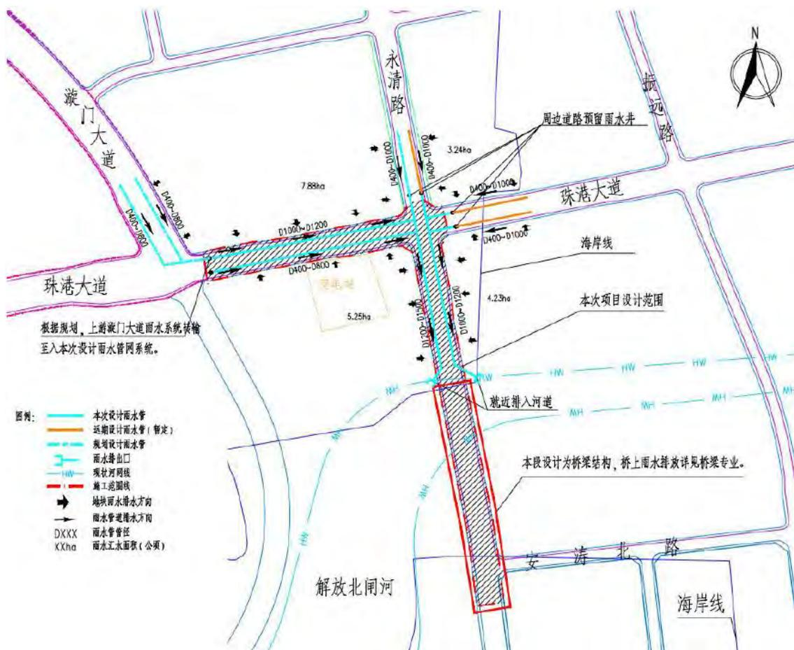
图3.3-13 工程雨水系统总平面图
