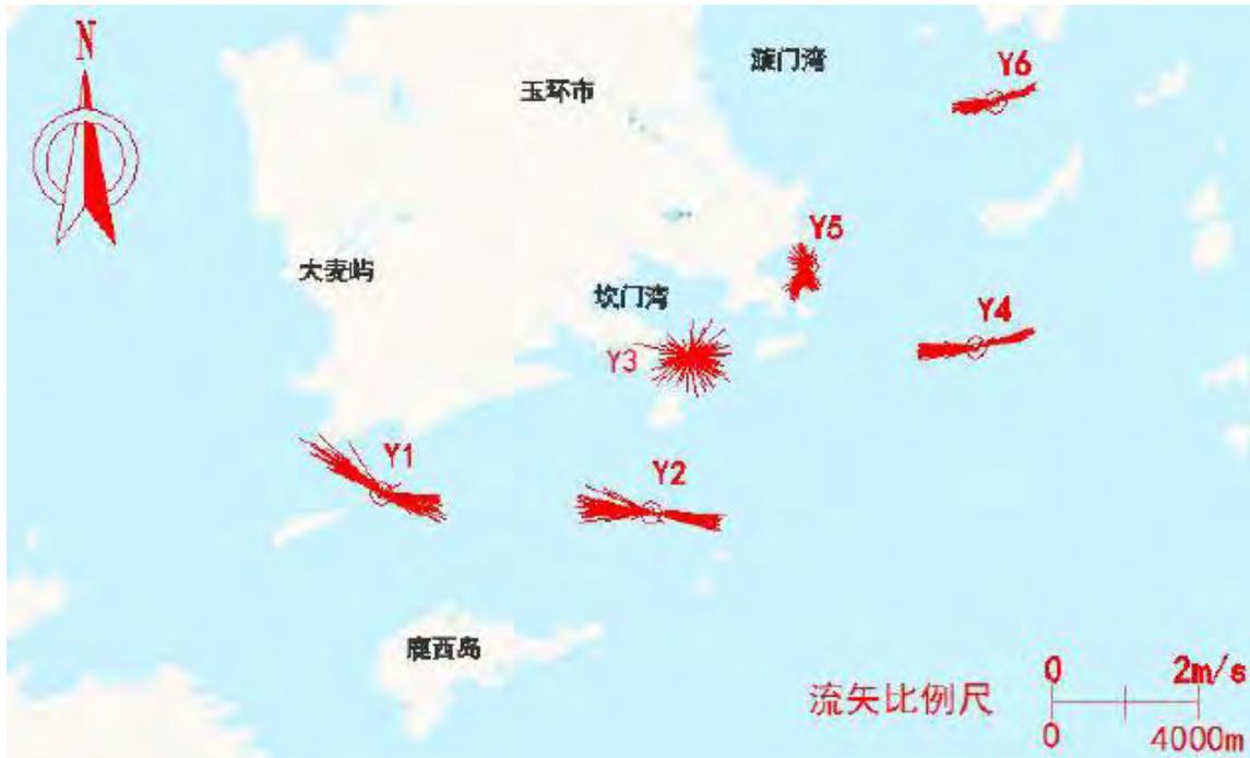
图4.1-6 大潮汛垂向平均的流速、流向矢量图（春季测次）
