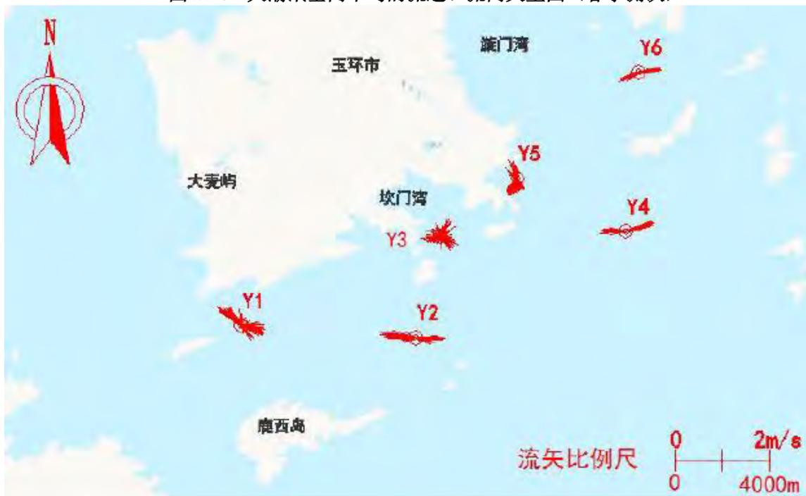
图4.1-7 小潮汛垂向平均的流速、流向矢量图（春季测次）
