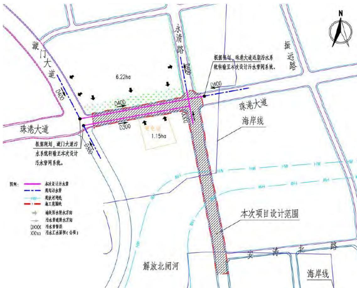
图3.3-14 工程污水系统总平面图
