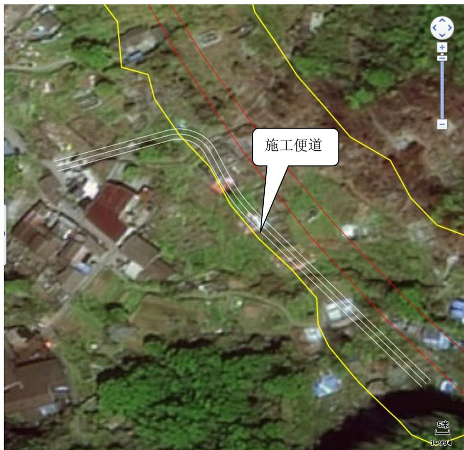
图 3.8-2 临时施工便道遥感影像图
