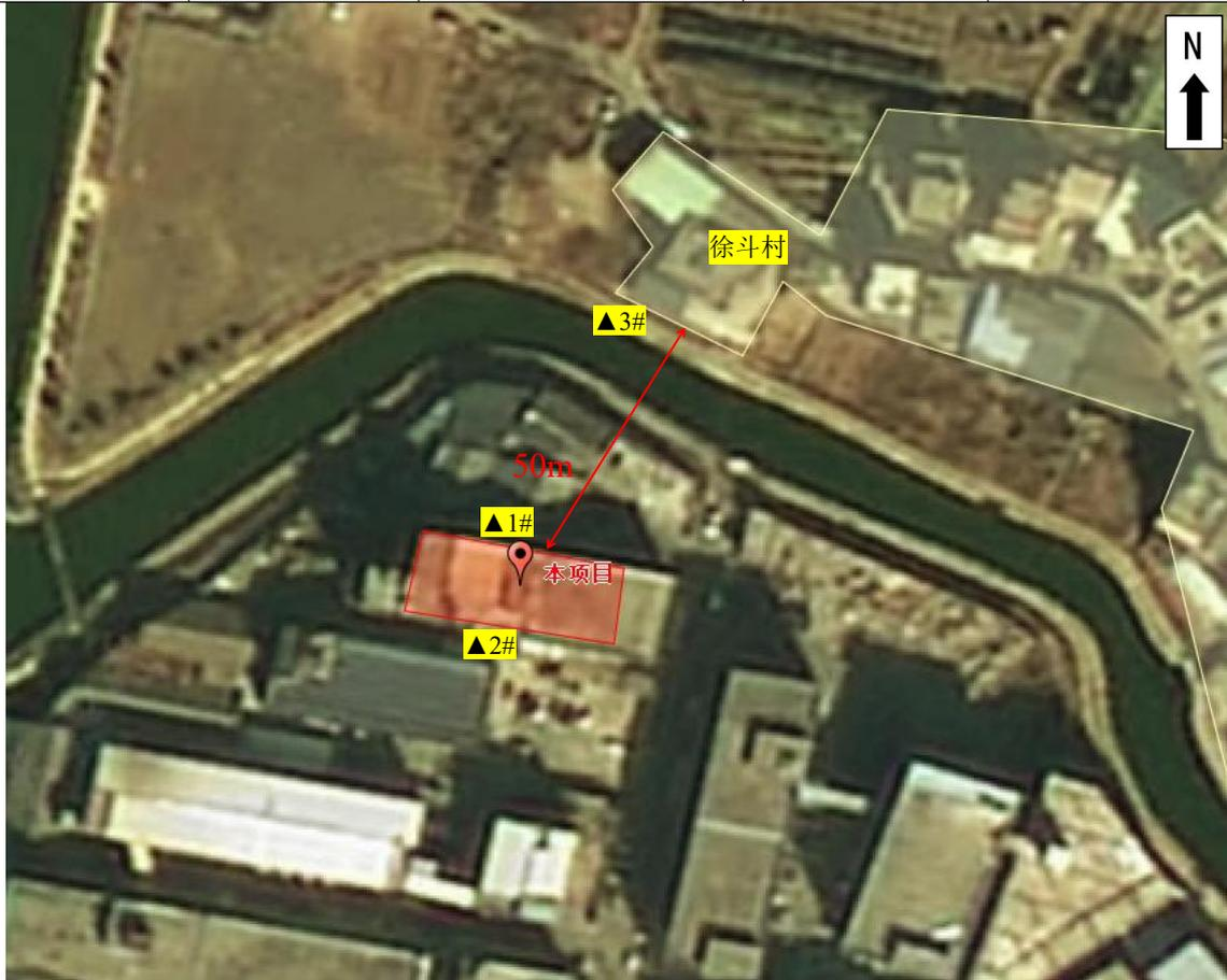
图 3-2 噪声监测点示意图
